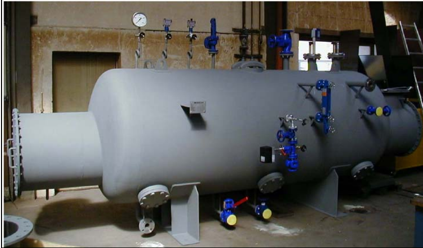
Figura n°4: Caldera recuperadora pirotubular
